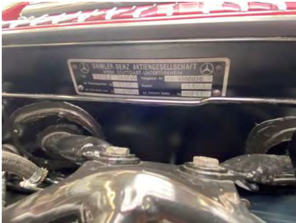
Typenschild an Feuerwand mit der FIN 198.040.4500020
