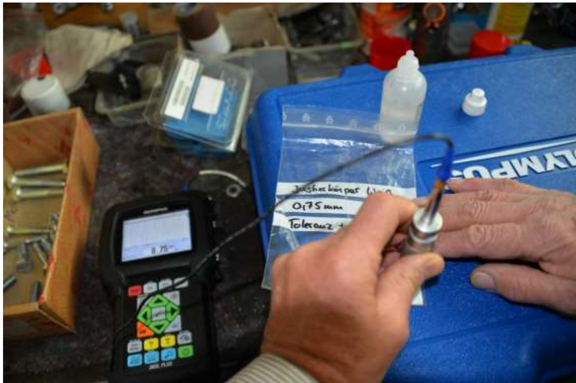
Kalibrierung des Messgerätes Olympus 38 DL Plus
