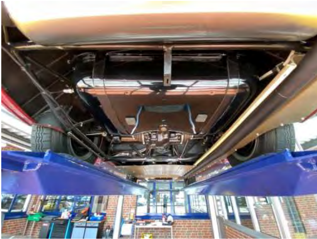
Rahmen / Bodengruppe Abdeckungen demontiert
