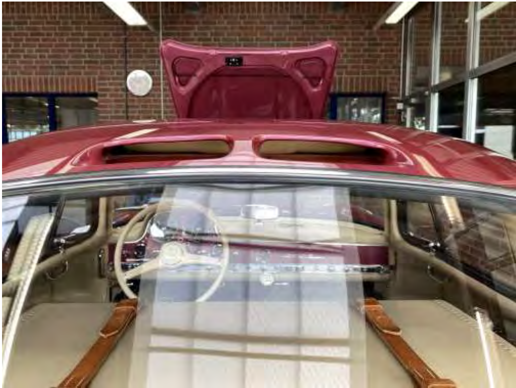
Entlüftungsschacht mit breitem Innensteeg (frühe Version)
