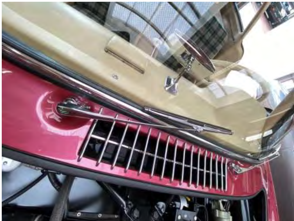
Lüftungsgitter mit Scheibenwischer
