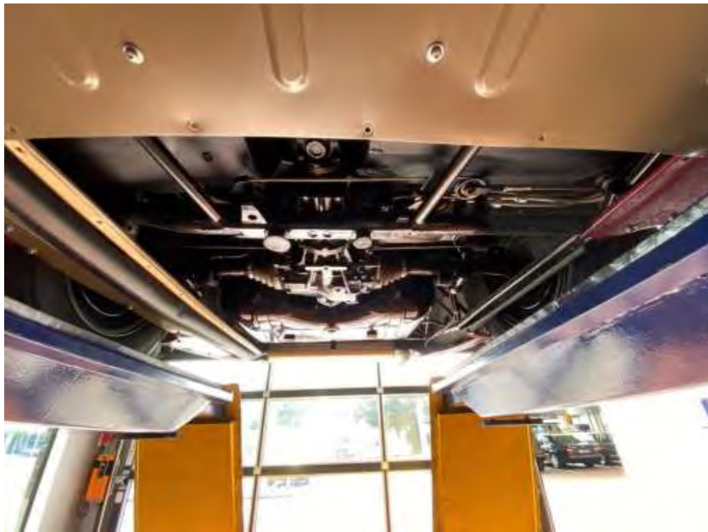
Rahmen / Bodengruppe Abdeckungen demontiert
