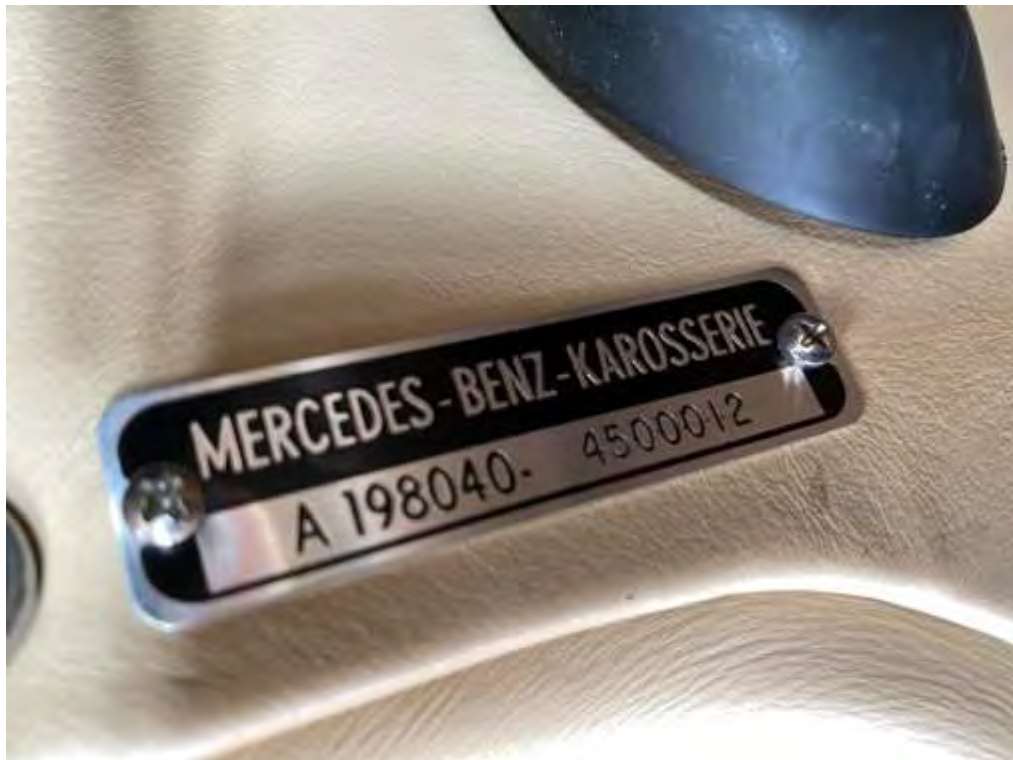
Aufbaunummer A 198040-4500012 -Typenschild
