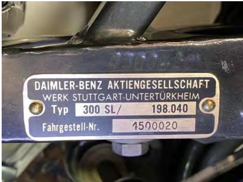
Typenschild mit Fahrgestellnummernprägung am Rahmen vorne links: 4500020
