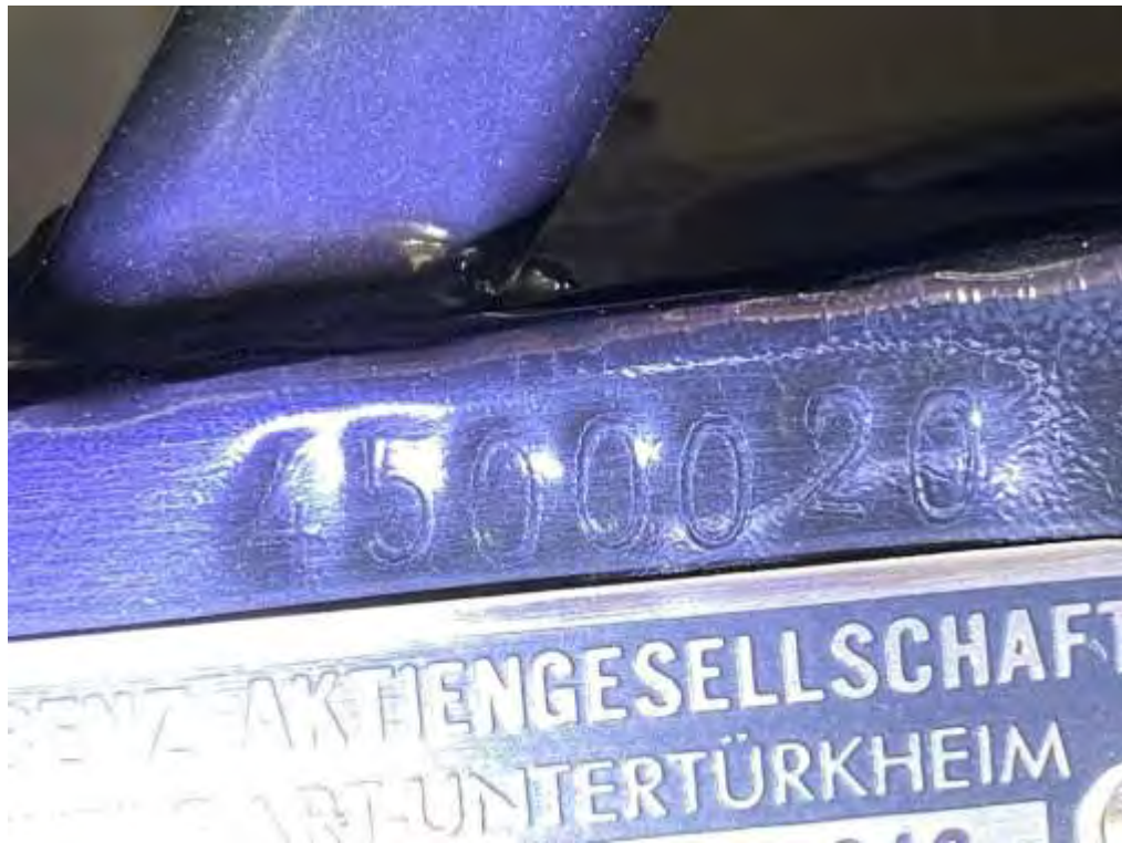
Fahrgestellnummernprägung am Rahmen vorne links: 4500020
