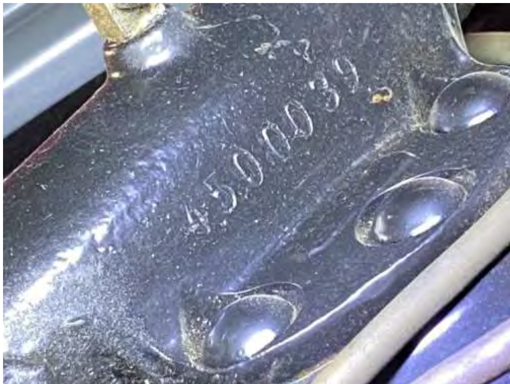
Vorderachsnurnmernprägung rechts Nr. 4500039 (matching)
