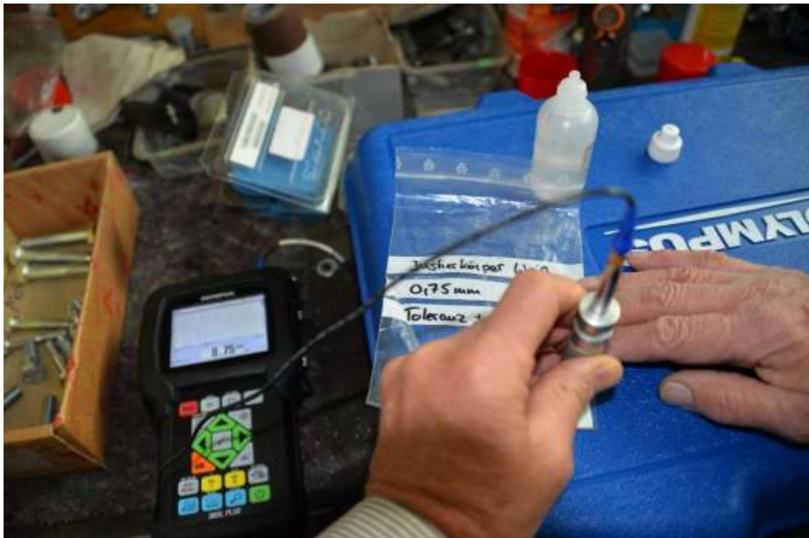
Kalibrierung des Messgerätes Olympus 38 DL Plus
