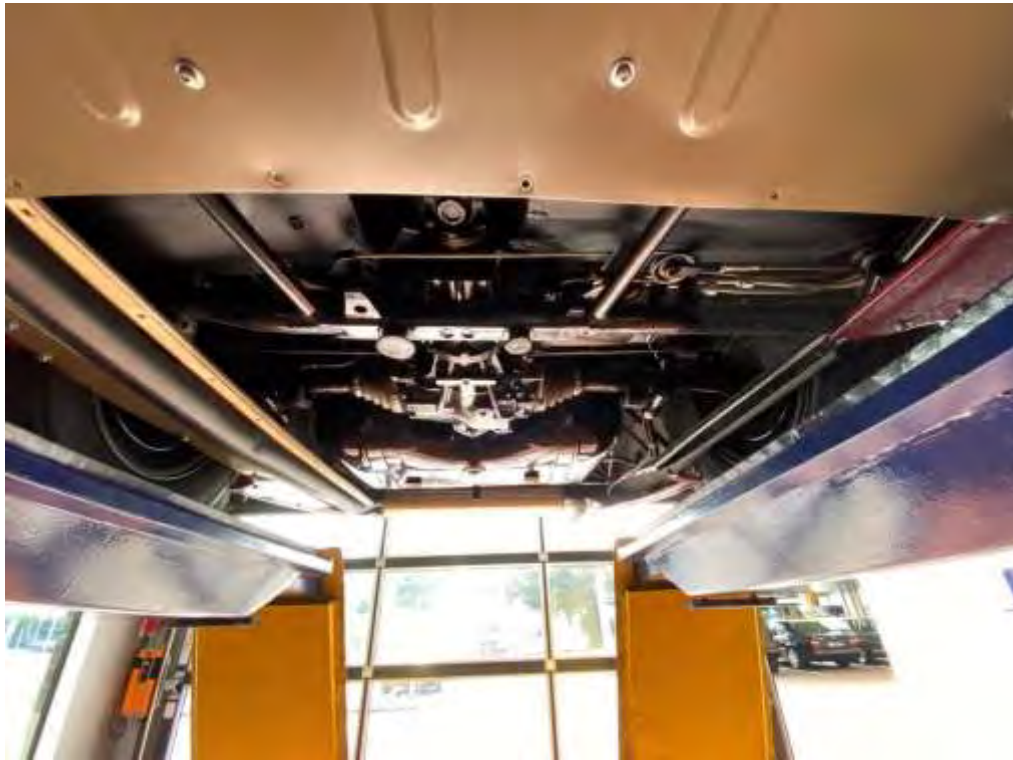
Rahmen / Bodengruppe Abdeckungen demontiert
