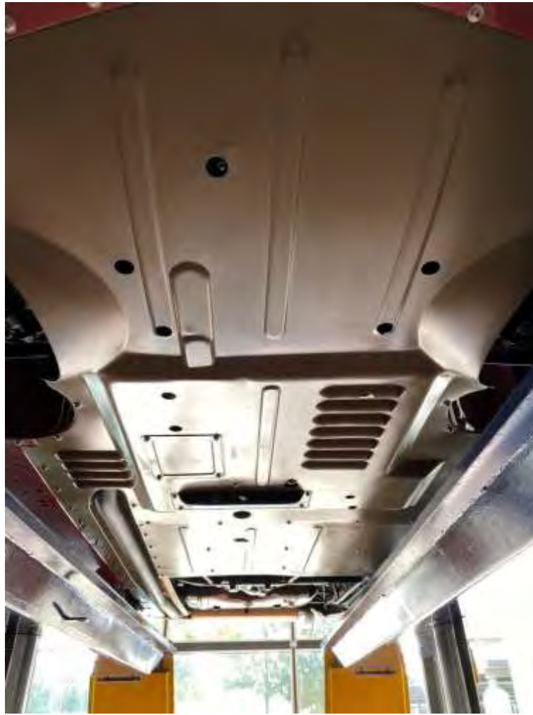
Rahmen /Bodengruppe Abdeckungen montiert
