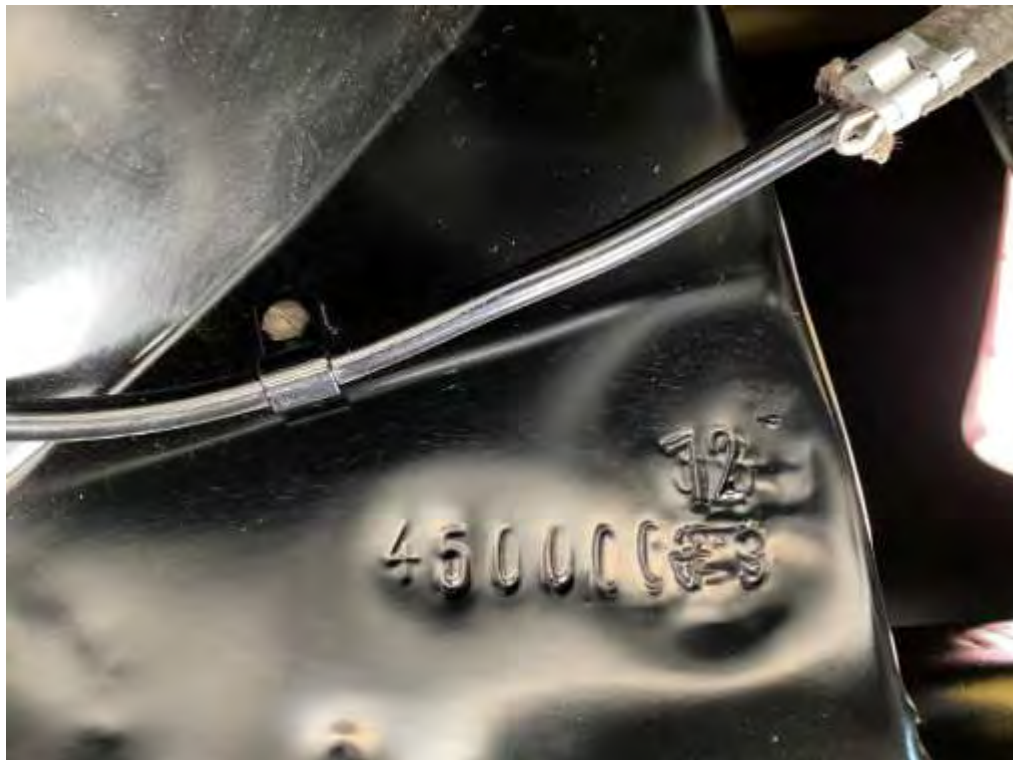
Karosserie- / Aufbaunummer 4500012 (starke Bearbeitungsspuren im Bereich der letzten 2 Ziffern mit mehrfachem Doppelschlag und verschiedenen Schlagzahlen)
