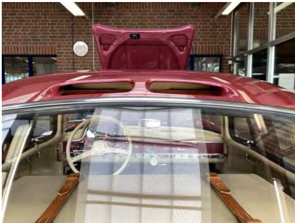
Entlüftungsschacht mit breitem Innensteeg (frühe Version)
