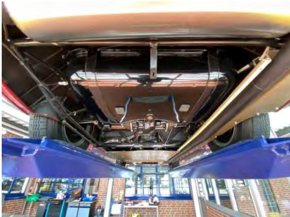
Rahmen / Bodengruppe Abdeckungen demontiert
