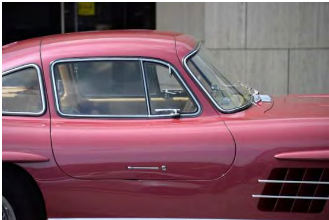
Spaltmaß rechte Tür / Mulde unter Türgriff rechts
