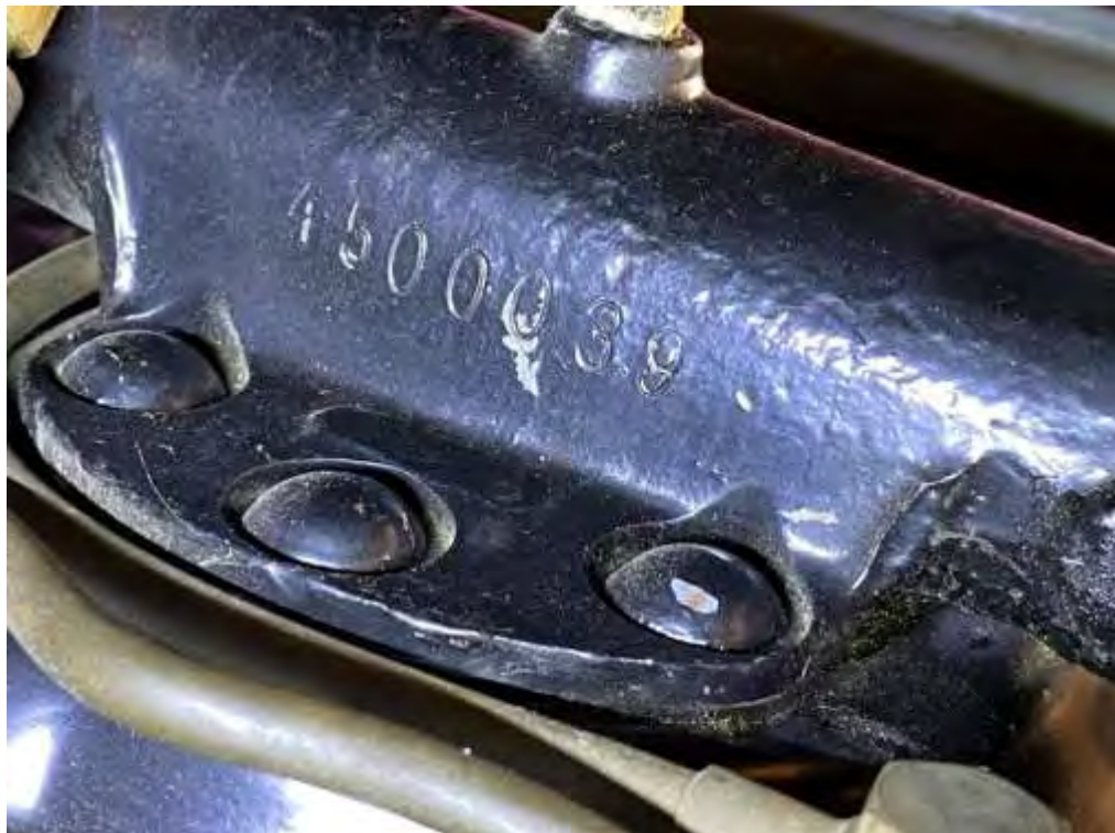
Vorderachsnurnernprägung links Nr. 4500039 (matching)
