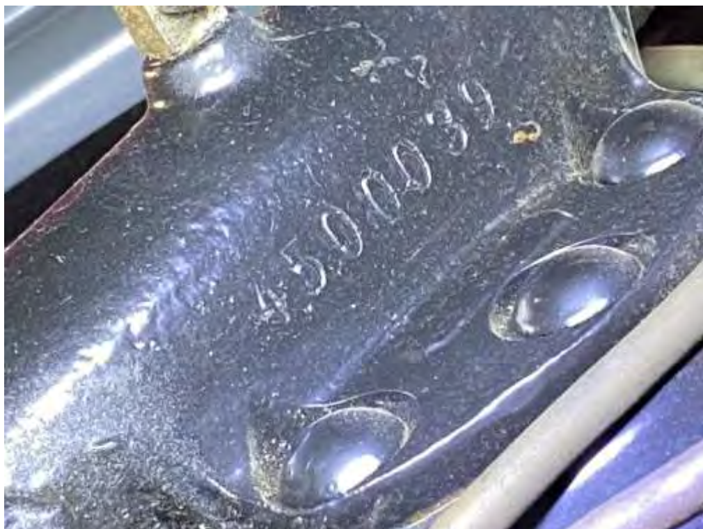
Vorderachsnummernprägung rechts Nr. 4500039
